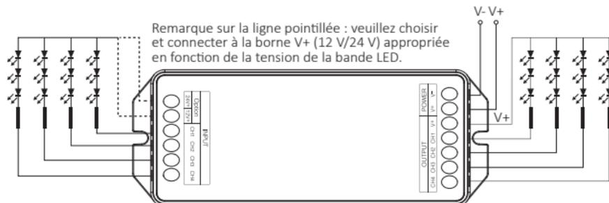
Attention: 1. La bande LED doit être DC12V ou 24V.
