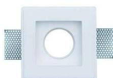
Supports constitués de plâtre renforcé. Ils se posent en encastré dans des parois de placo-plâtre au plafond. Une fois les joints réalisés, ils sont totalement invisibles et peuvent être peints. Un clip de fixation permet de fixer l'ampoule.
